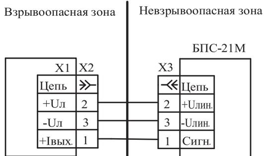
Подключение датчиков ДАХ-М-05, -05Х, -06ТР, -06ТРХ; ДАТ-М-05, -05Х, -05Г, -05ГХ; ДАК-26...-30, -35...-38, -126...-139; ДАФ-М-05Х к БПС-21М
