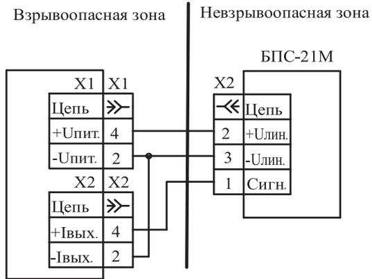
Подключение датчиков ДАХ-М-06ТРХН, -06ТР, -06ТРХ; ДАТ; ДАК-26...-30, -35...-38, -126...-139; ДАТ-М-06, -06Г, -06ТР, -06ТРХ, -06ТРХН, -06ГТР, -06ГТРХ, -06ГТРХН; ДАФ-М-06ТРХ к БПС-21М-М
