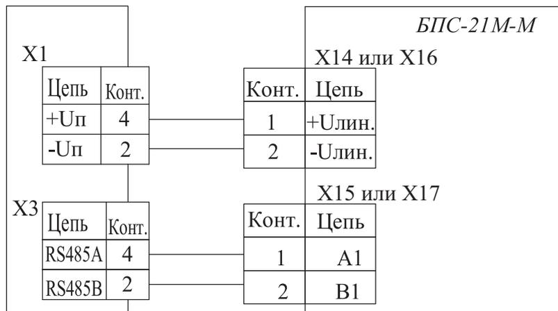
Подключение датчиков ДАТ-М-06ТРХН, -06ГТРХН к БПС-21М без барьера с дополнительным источником питания
