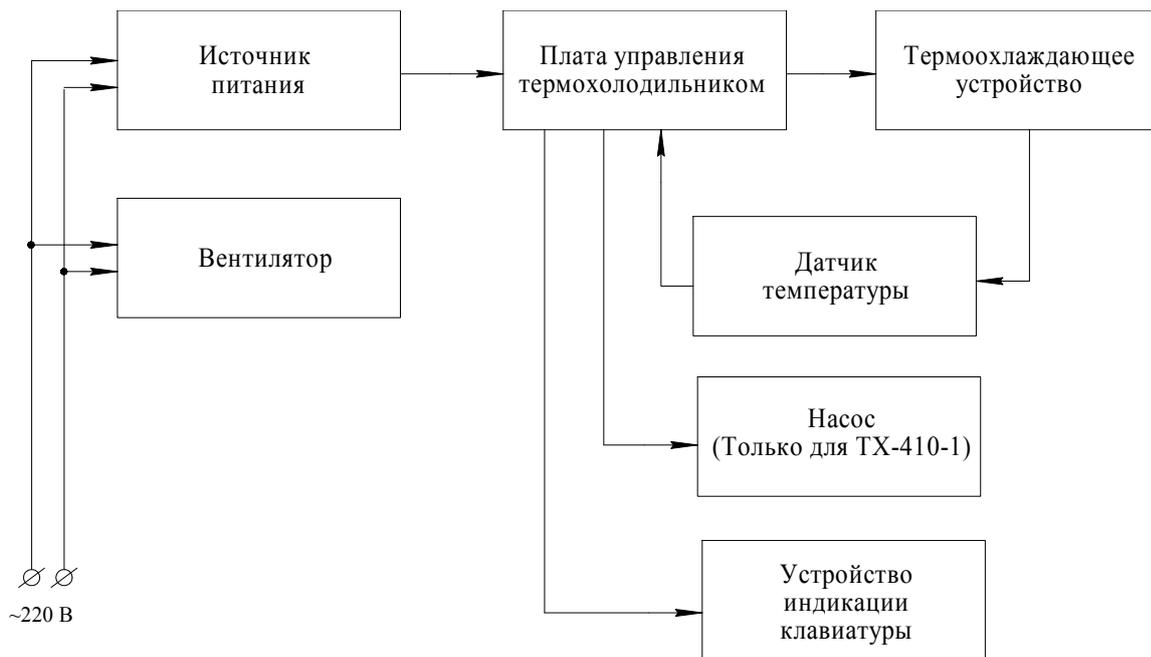
Рисунок 1.2 – Функциональная схема
