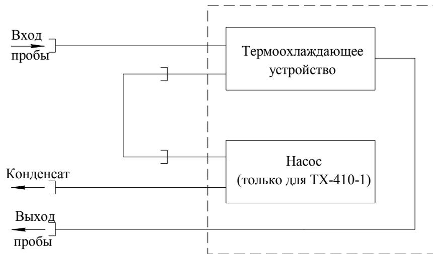
Рисунок 1.3 – Пневматическая схема
