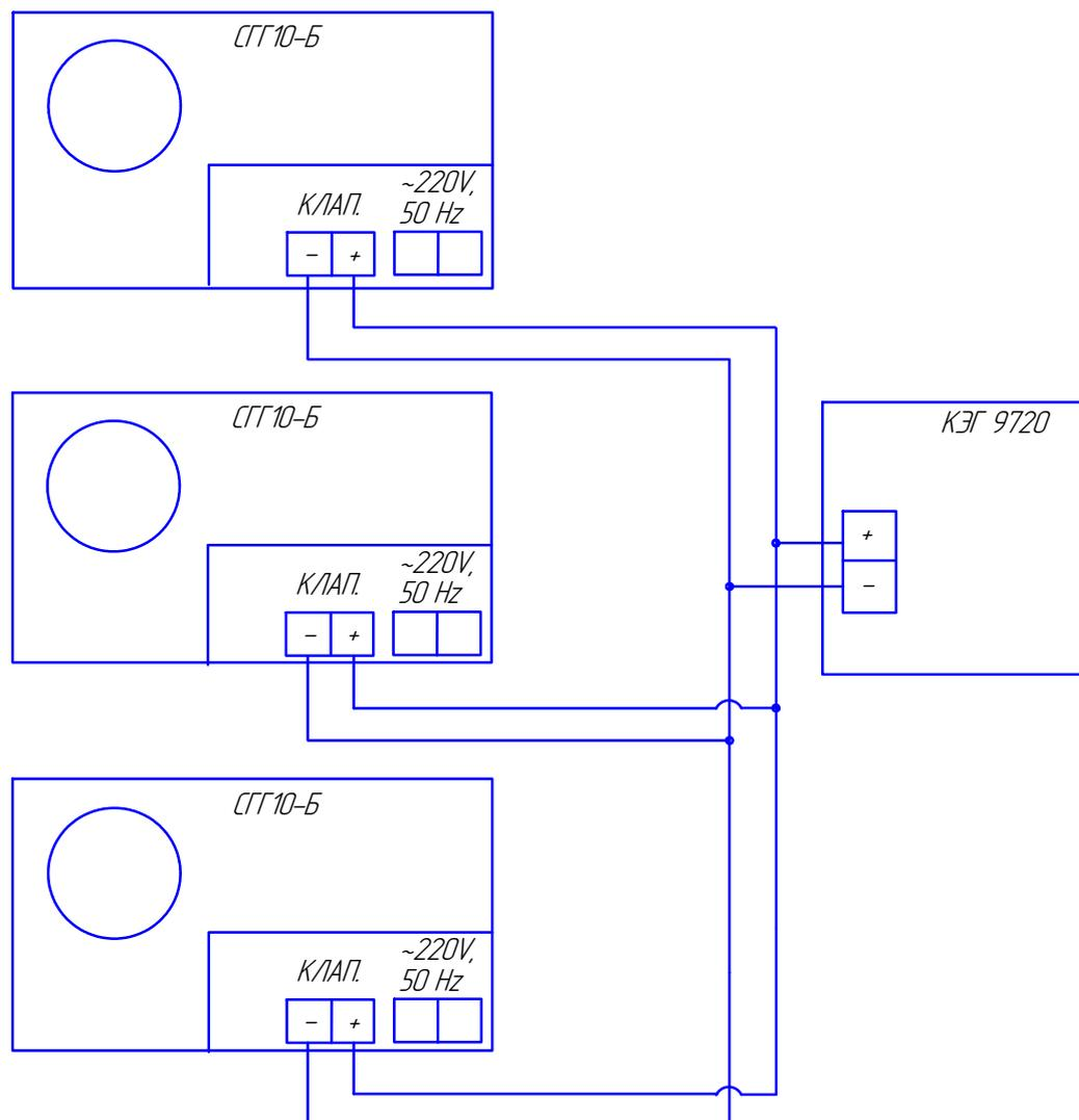
Допускается подключение до трех сигнализаторов к одному клапану.
