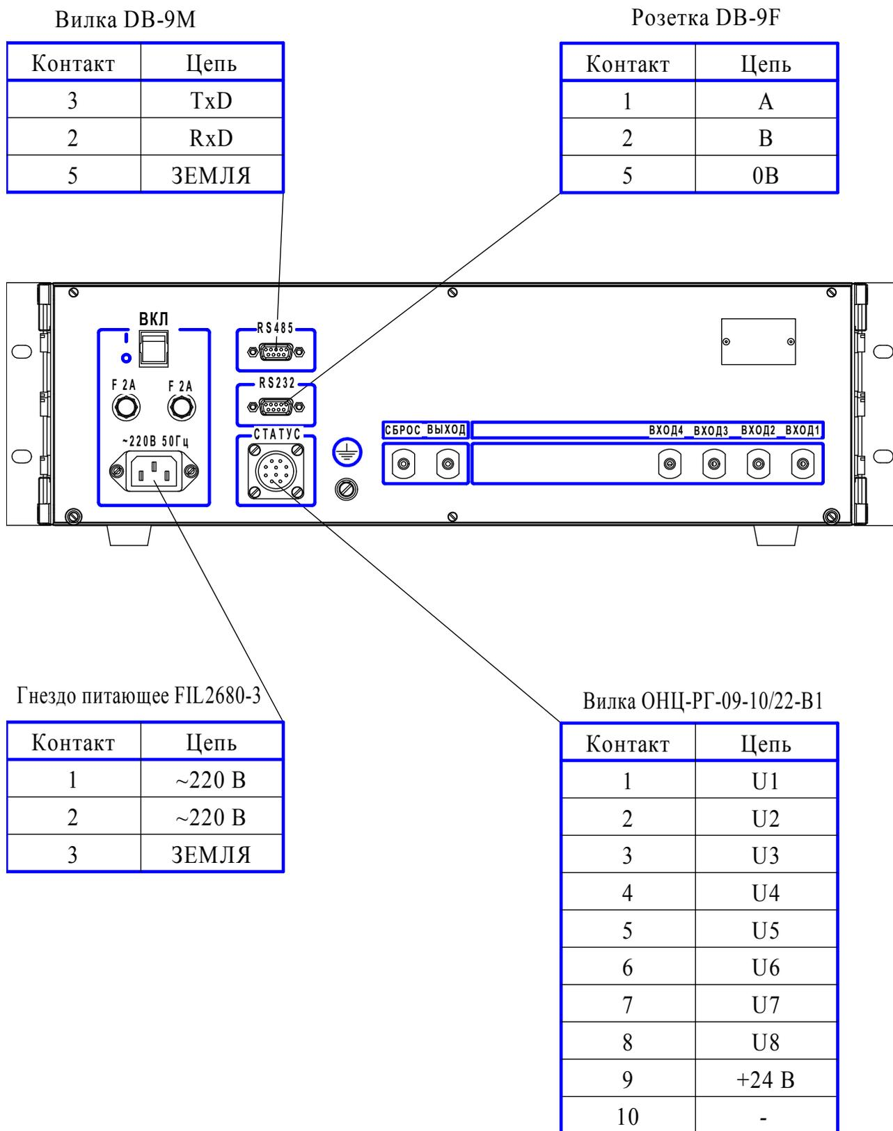
Рисунок 2.2 - Распределители газовые РГМ-4. Схема подключений
