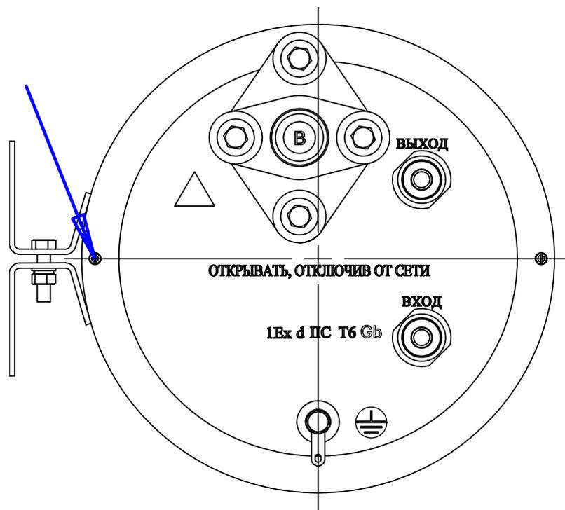
Стрелкой указано место пломбировки от несанкционированного доступа.
