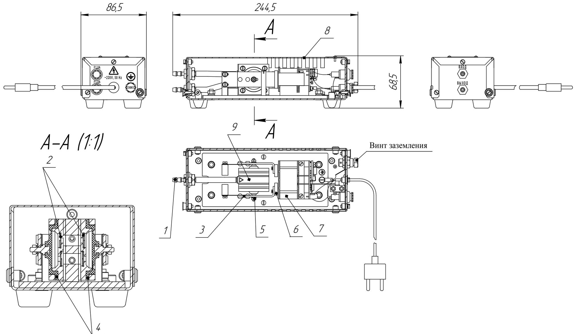
1 -штуцер ; 2 - блок клапанов; 3 - рычаг; 4 - мембрана; 5 - гайка; 6 - магнит; 7 - дроссель; 8 - кожух; 9- корпус.
