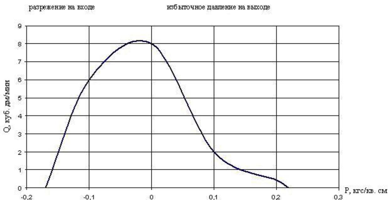
Рисунок 2.1 – Характеристика производительности побудителя расхода по воздуху
