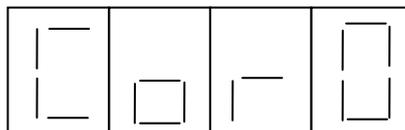
Нажать кнопку "↶" и ввести с помощью кнопок "▽" и "△" значение концентрации ГСО-ПГС № 1. Для занесения его в память газоанализаторов нажать кнопку "↶", на дисплее индицируется поочередное свечение центральных горизонтальных сегментов. При этом произойдет переход в основное меню.
