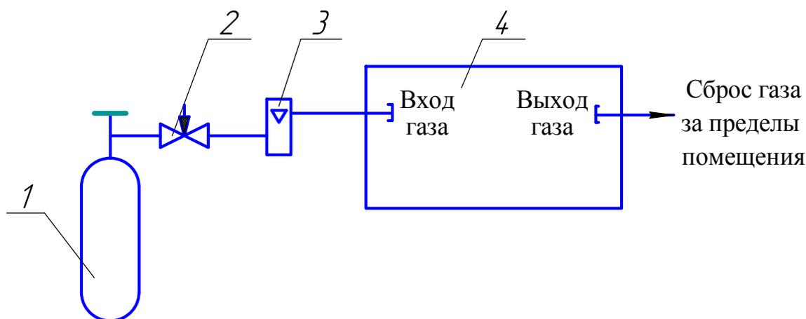
1 – баллон с ГСО-ПГС; 2 – вентиль точной регулировки;
