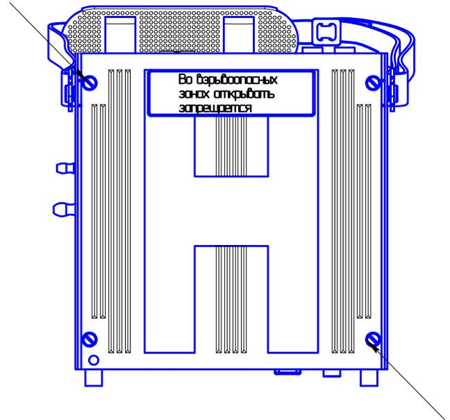
Стрелками указаны места пломбировки газоанализатора от несанкционированного доступа и обозначение места для нанесения оттисков клеем.
