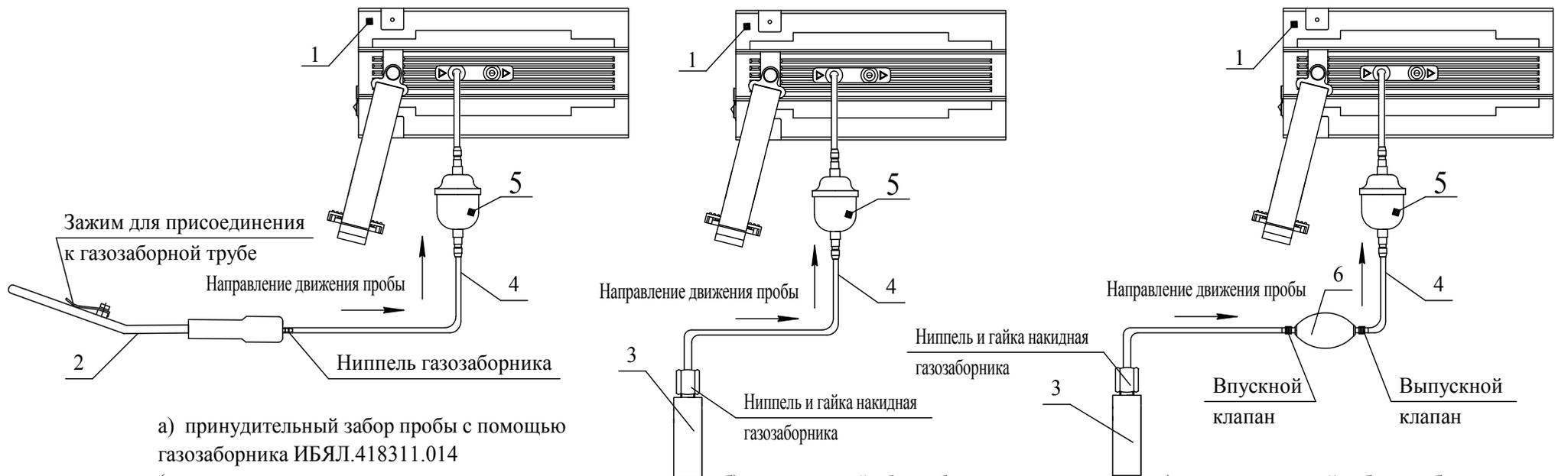
а) принудительный забор пробы с помощью газозаборника ИБЯЛ.418311.014 (температура окружающего воздуха от минус 10 до 40 °С)
