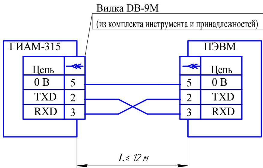
Рисунок 2.3 – Схема подключения газоанализатора к ПЭВМ
