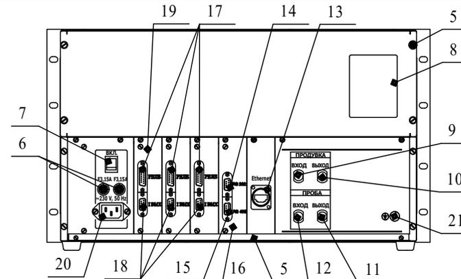
а) газоанализаторы ГАММА-100 (три измерительных канала)
