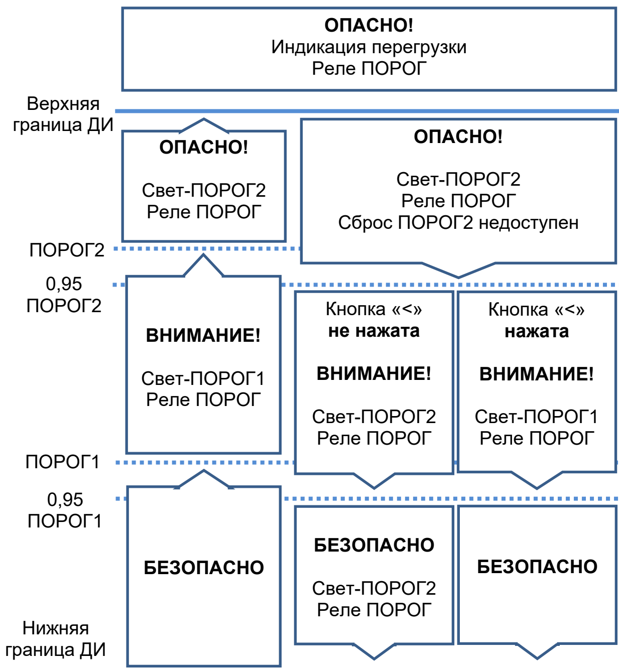
Рисунок 1.3 – Работа сигнализации загазованности
