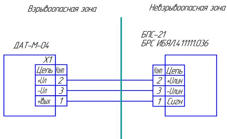
При необходимости использования пульта контроля схема подключения будет иметь вид:
