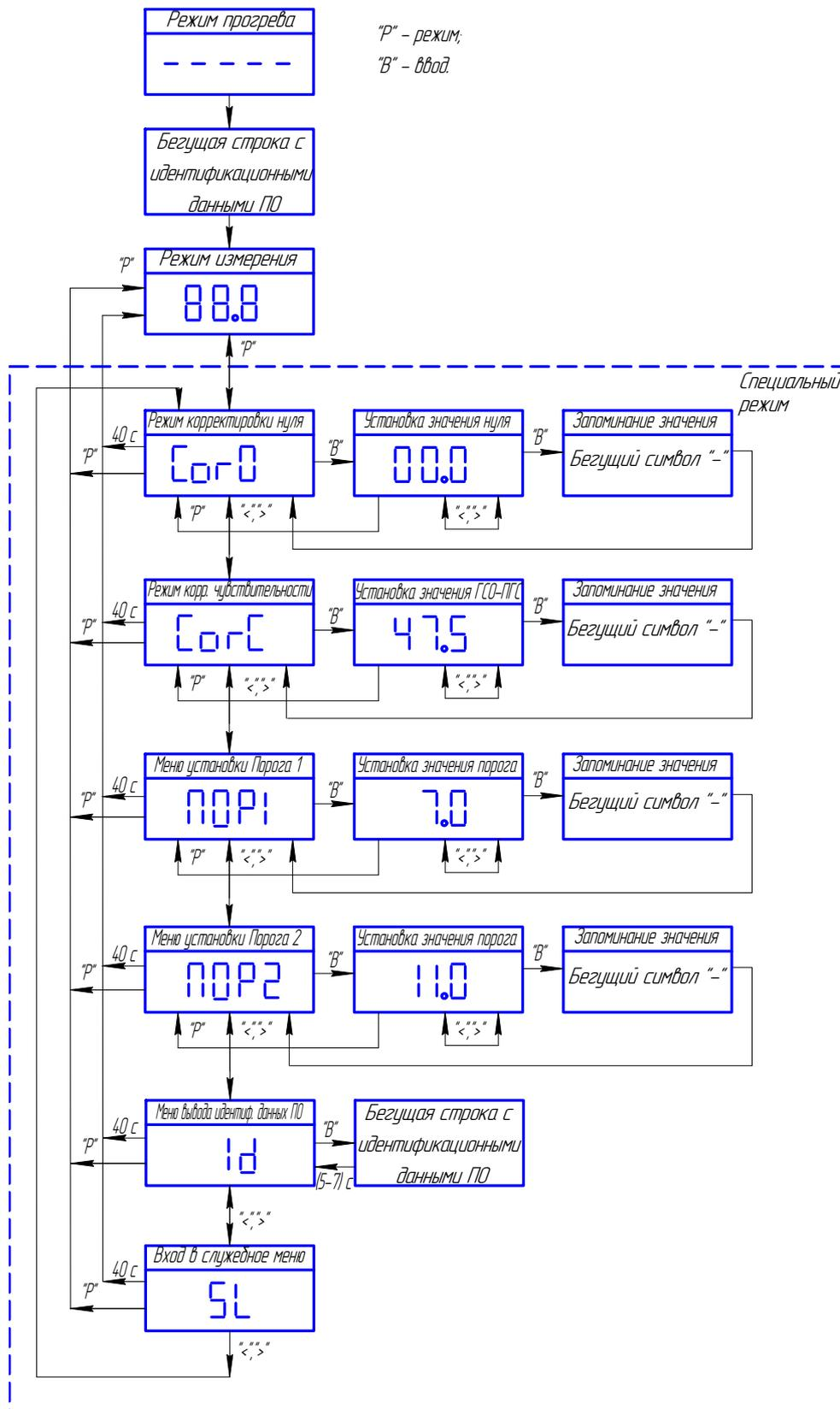
Рисунок В.1 – Сигнализаторы ДАТ-М-01. Схема режимов работы
