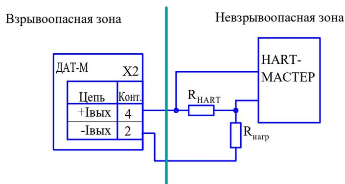
Примечание - Суммарное сопротивление  $R_{HART}$  и  $R_{нагр}$  не более 600 Ом
