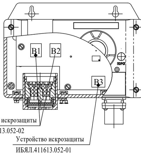
1. Чувствительные элементы и токоподводящие проводники датчика ИБЯЛ.413226.065 сигнализаторов всех исполнений заключены во взрывонепроницаемую оболочку, соответствующую требованиям ГОСТ ИЕС 60079-1-2011. Оболочка состоит из основания, стакана и держателей.
