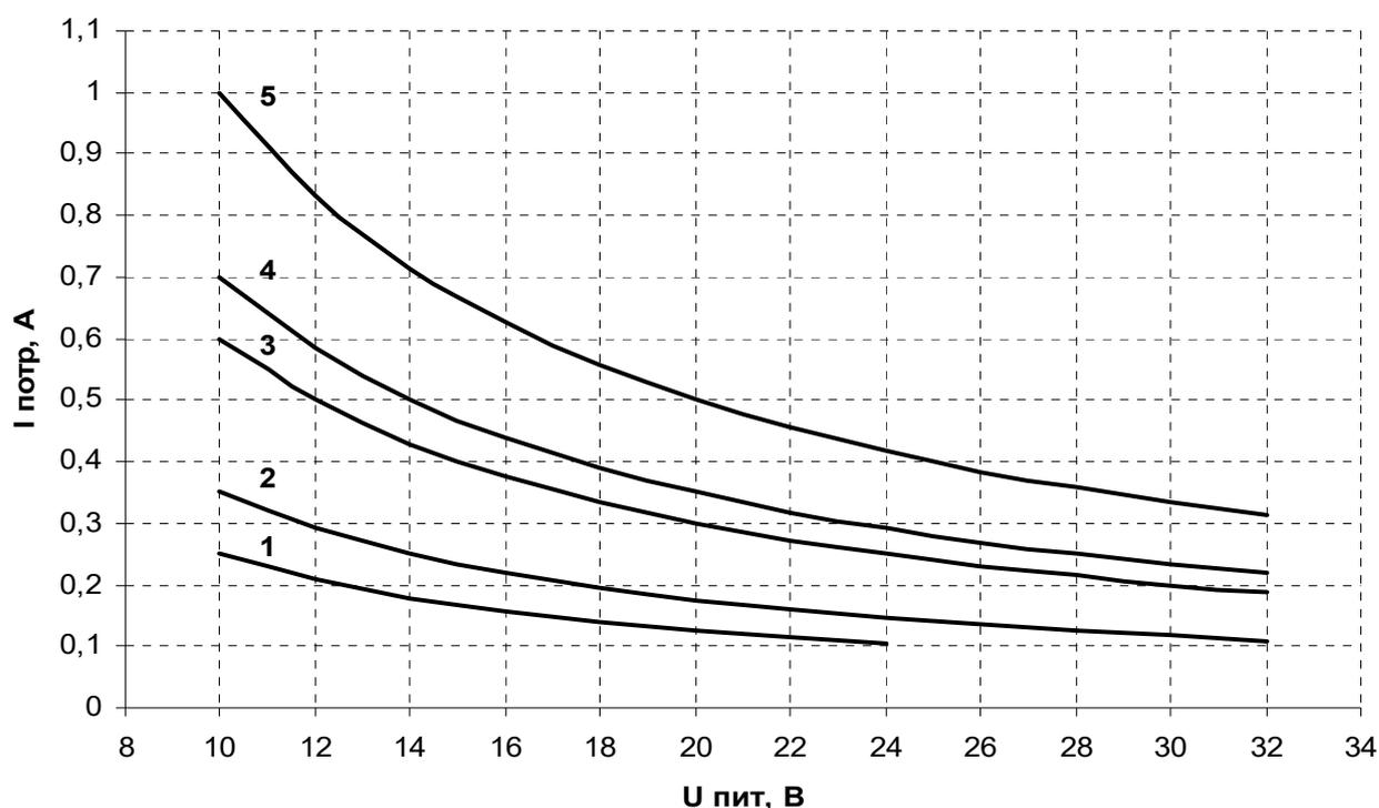
Рисунок 2.1 – Зависимость тока потребления сигнализаторов от напряжения питания
