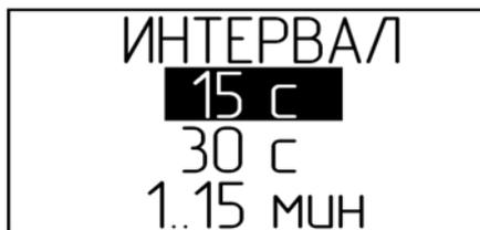
Рисунок 2.9 – Меню выбора интервала записи в архив газоанализатора
