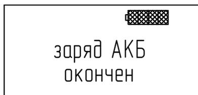
Рисунок 3.2 – Режим окончания заряда батареи аккумуляторной
