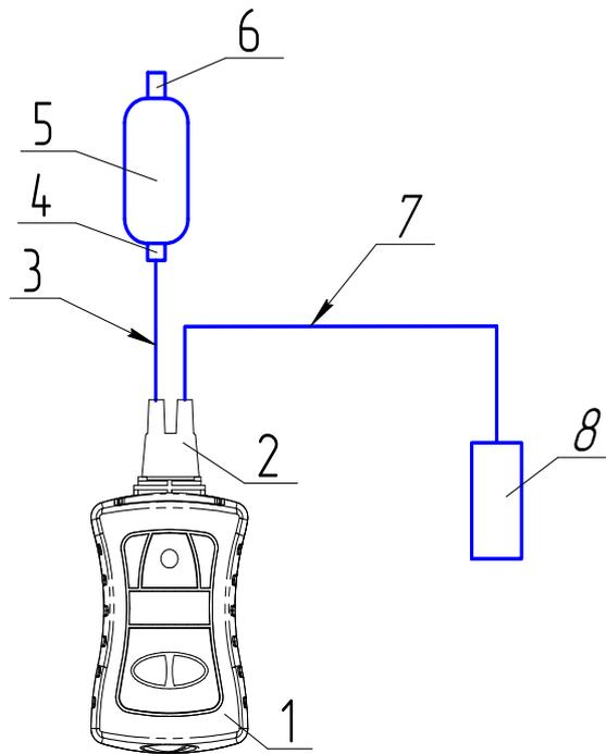
1 – газоанализатор; 2 – колпачок поверочный; 3 – трубка ПВХ 4x1,5, длина 1 м;
