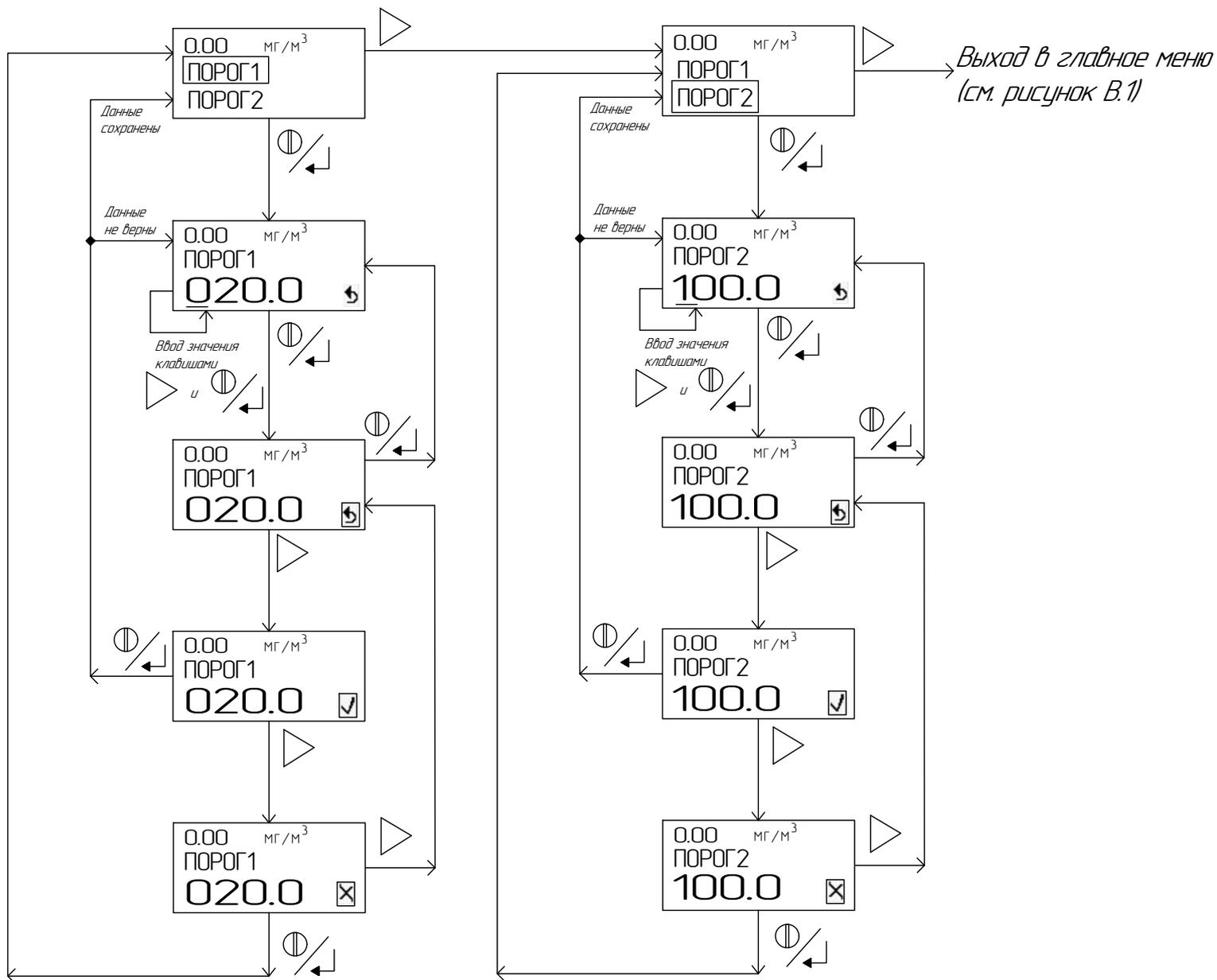
Рисунок Г.2 – Схема режимов работы. Режим установки пороговых значений
