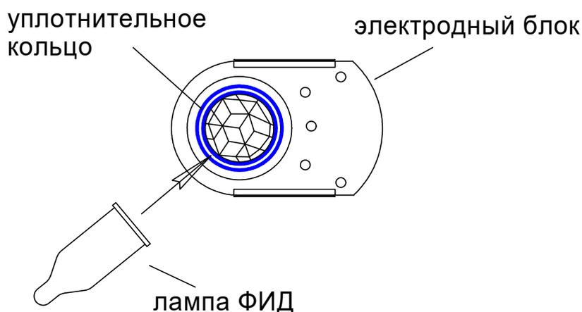
Рисунок 4.4 – Установка лампы ФИД
