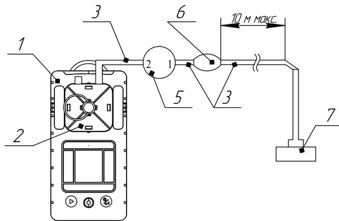
а) принудительный отбор пробы с помощью пробозаборника ИБЯЛ.418311.050
