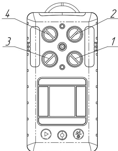
Рисунок 3.2 – Последовательность расположения каналов в газоанализаторе
