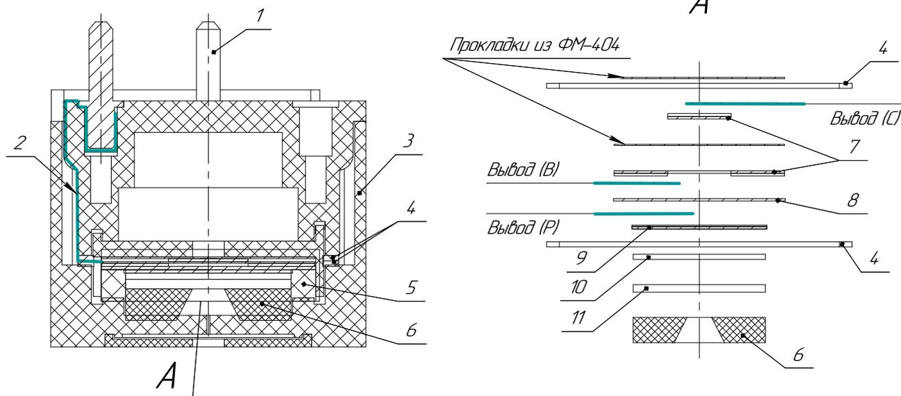
Рисунок 7.2 – Датчик кислорода в разрезе
