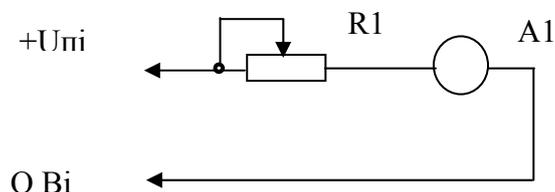
R1 – резистор СП5-35Б–10 кОм; A1 – вольтамперметр M2044;
