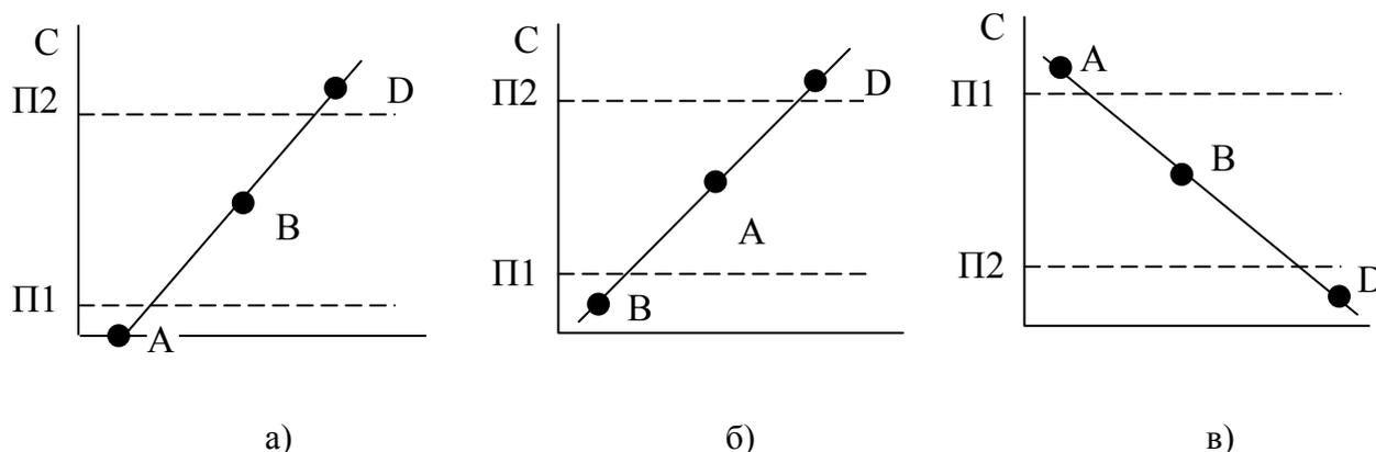
Зона А – диапазон содержания определяемого компонента, при котором не происходит срабатывания сигнализации;
