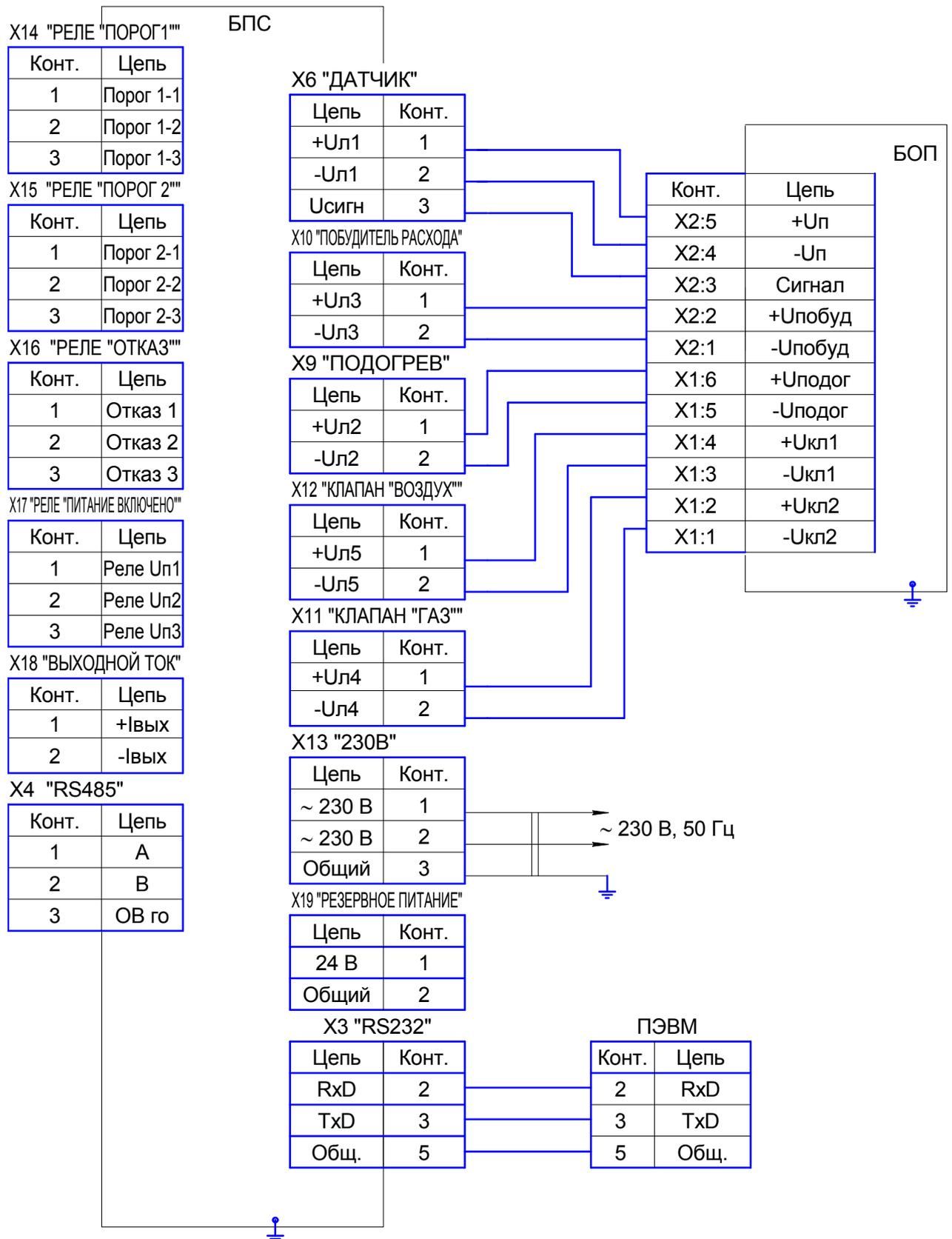
Рисунок 2.1 - Схема соединений БОП и БПС
