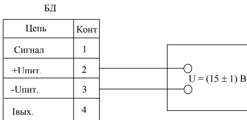
Рисунок 3.2 – Схема соединения БД с источником постоянного тока
