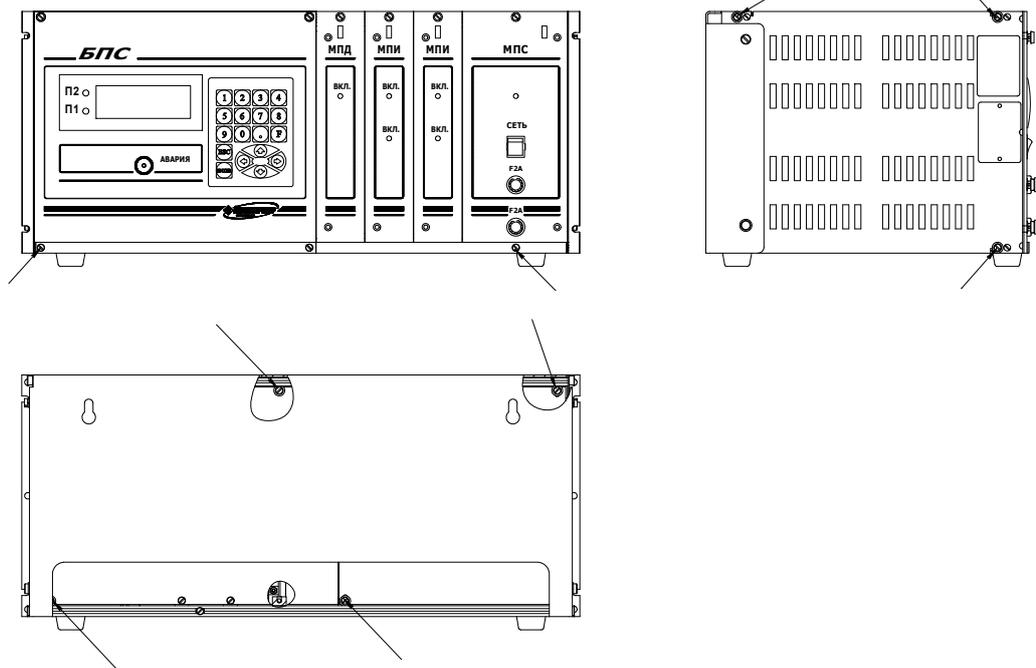
Стрелками указаны места пломбировки от несанкционированного доступа и обозначение мест для нанесения оттисков клейм
