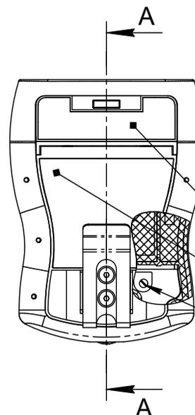
Табличка ИБЯЛ.754312.465 ... -75 выполнена из металлизированного пластика с гравировкой основных параметров газоанализатора и взрывозащиты по ГОСТ 31610.0-2014. В зависимости от исполнения (от определяемых компонентов) газоанализатор может иметь маркировку:
