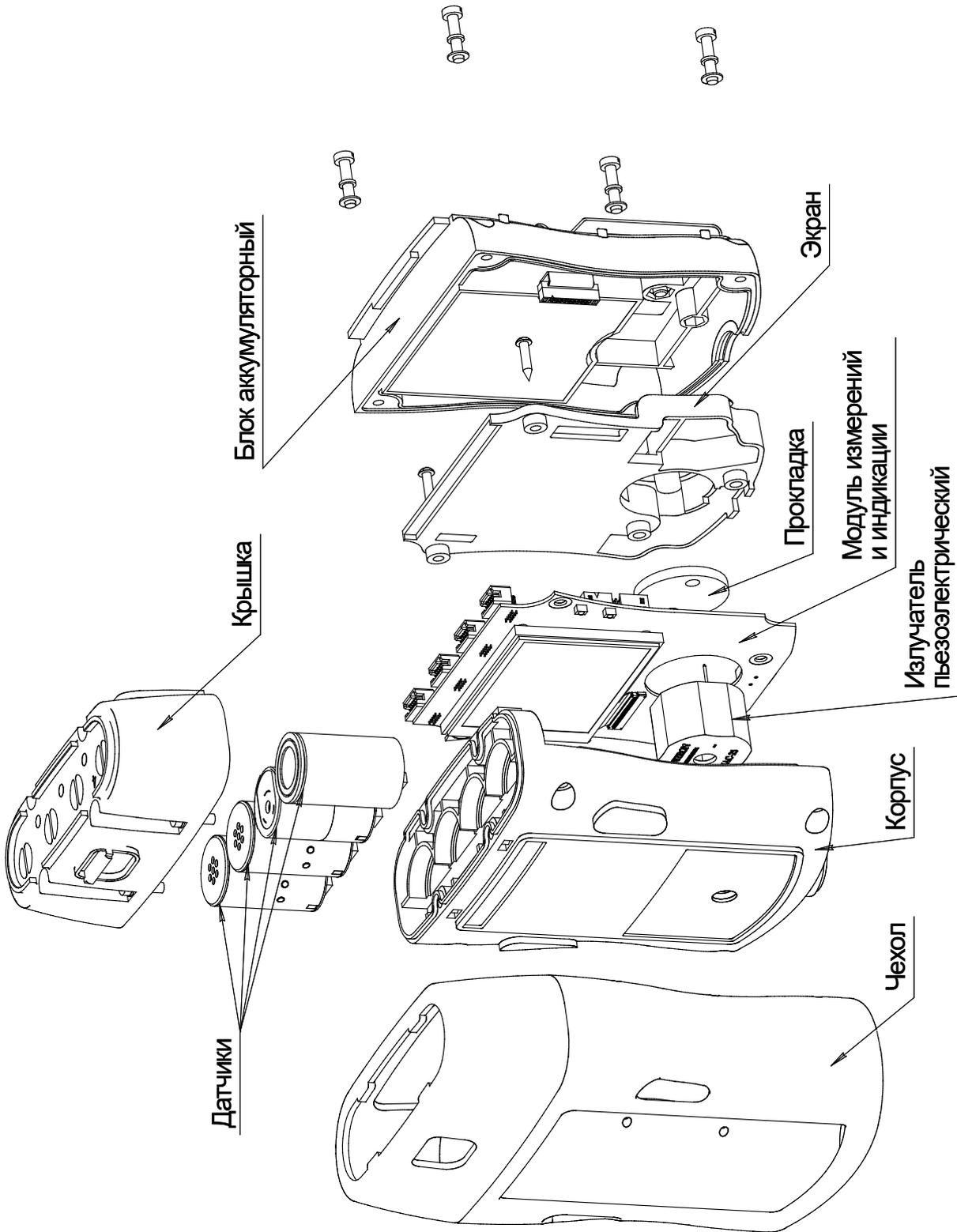
Рисунок 1.3 - Устройство газоанализаторов
