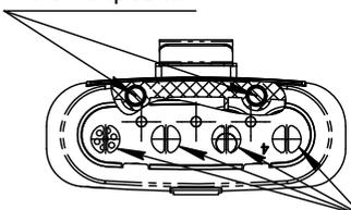
В зависимости от исполнения газоанализатора могут быть установлены ЭХЯ ИБЯЛ.418425.060-20, ИБЯЛ.418425.100-10...-17, датчик кислорода ИБЯЛ.418425.010-18, ИК-датчик МИД-82 ИБЯЛ.418414.106-32...-37, термохимический датчик ИБЯЛ.413226.075-01, датчик фотоионизационный PID-A1 или PID-A12 (сертификат о соответствии требованиям взрывозащищенного оборудования Baseefa07ATEX0060U), датчик фотоионизационный ФИД-С4.0 ИБЯЛ.418419.019
