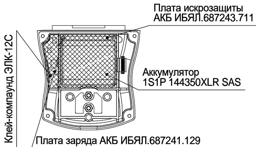
**Схема заливки аккумулятора LP924152LC-PCM-LD или LP104453LC-PCM-LD**
