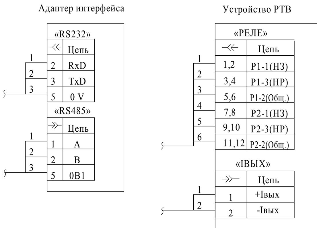
Рисунок 2.1 – Схема распайки разъемов устройства РТВ и адаптера интерфейса.
