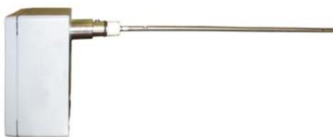
Пылемер – моноблочный прибор в металлическом корпусе, с погружным датчиком-стержнем, крепящимся к корпусу через изолятор. Длина погружной части 750, 1000 обеспечивается стержнем-насадкой к базовой длине, равной 500 мм. Длина погружной части 1500 мм обеспечивается двумя дополнительными стержнями-насадками длиной 500 мм каждая к базовой длине, равной 500 мм.
