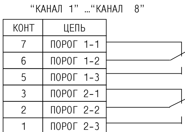
Рисунок 8.1 – Схема подключения внешних исполнительных устройств
